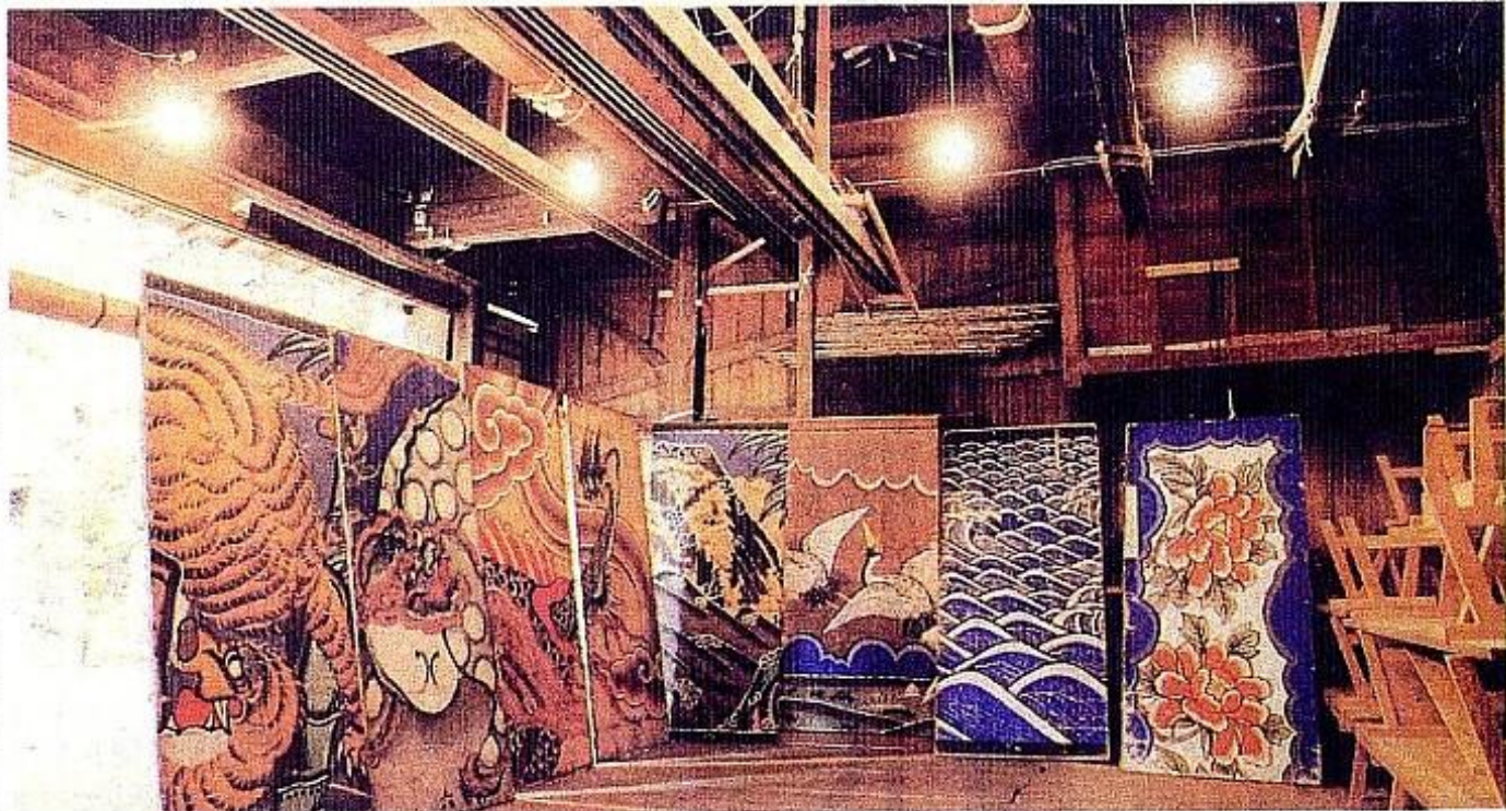
舞台内部。泥絵の具で描かれたふすま絵は、薄暗い明かりの中で鮮やかによみがえり、光り輝く。上につるされた5本の鴨居は「ふすまからくり」の装置であり、敷居は上演時に鴨居からつるされる
